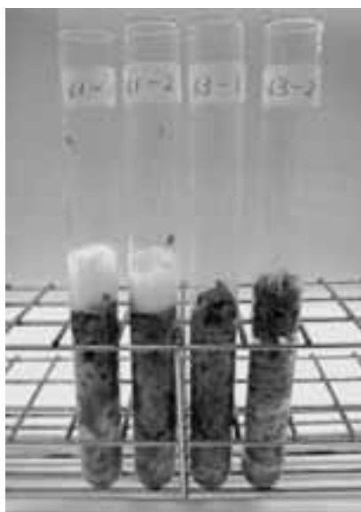
図1.牛ミンチ肉の過酸化水素添加時のカタラーゼ反応 左2本: 61℃加熱 右2本: 63℃加熱
